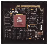
Lo scheletro del microprocessore chip può facilmente essere sostituito per permettere l'upgrade delle caratteristiche dell'analisi. In questo caso è ben visibile il 486 a 33 MHz di clock.
